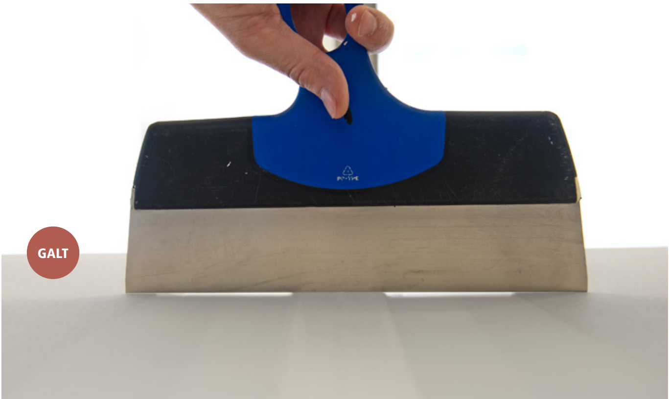
For tykt sparkellag under sparkelremsen. Sparkelremsen ligger for langt ut i fra plateskjøten.
